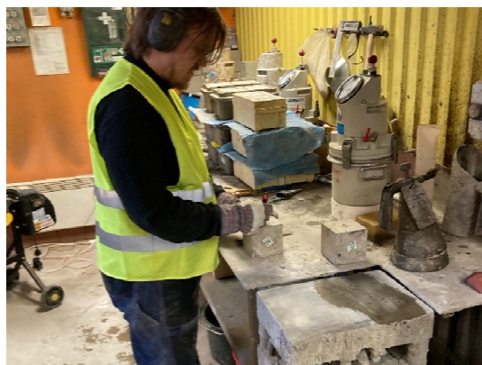
BILD 6. Avformning och rengöring av proverna. Vibrationsplatta närmast kameran.
