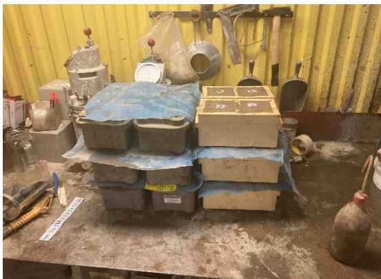
BILD 5. Betongproverna i gjutformarna. Två olika typer av formar på bilden.
